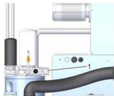
Рис. 11: Клапан минимального давления с функцией обратного клапана
