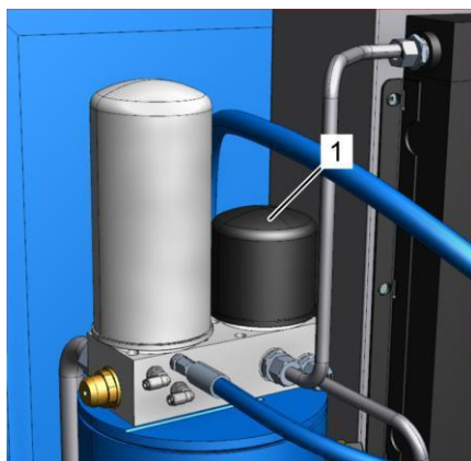
Рис. 46: Демонтаж фильтра охлаждающей жидкости
