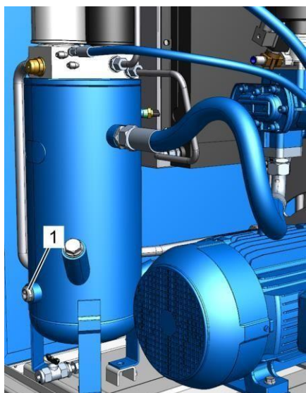
Рис. 32: Проверка уровня охлаждающей жидкости через смотровое отверстие
