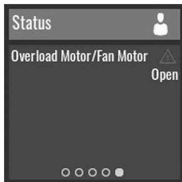
Экран выключения, перегрузка
